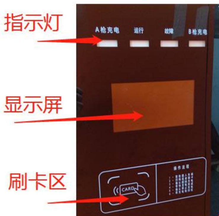
图 1-1 充电桩操作区示意图
