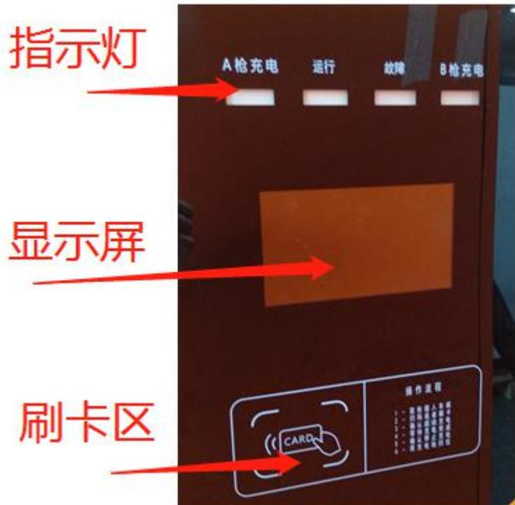
图 1-1 充电机操作区示意图
