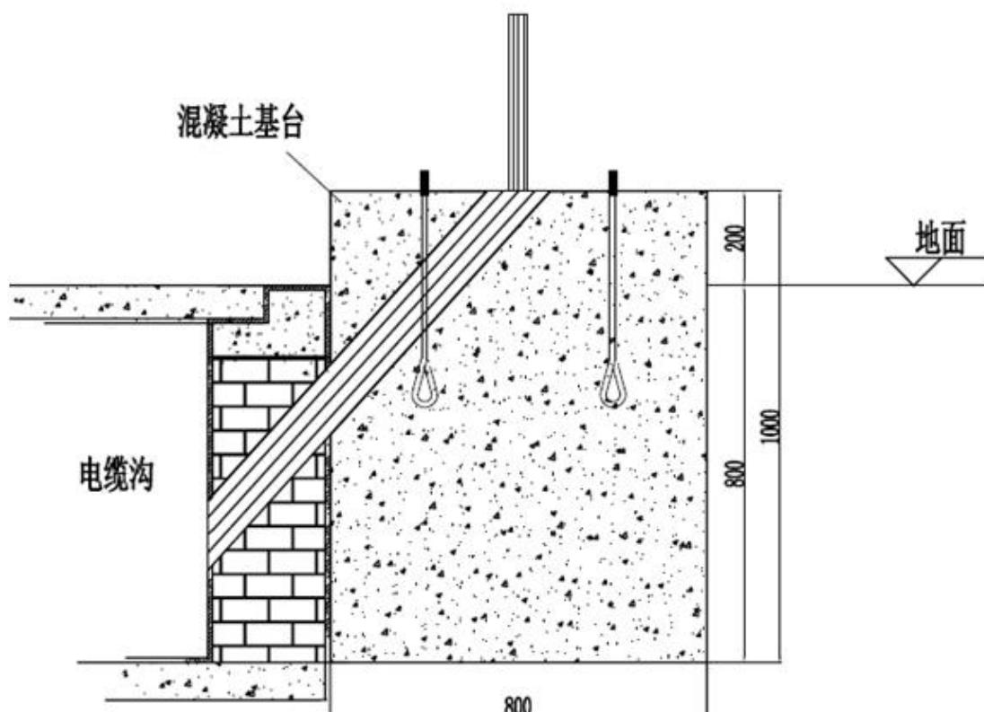
混凝土基础剖面图
